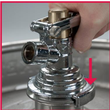
3. Montieren Sie das Demontagewerkzeug wie bei einem normalen Zapfkopf und drücken Sie den Hebel hinunter bis zum Anschlag. Der Sicherheitsriegel wird eingezogen.
