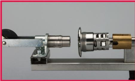
1. Legen Sie den Fitting in das Werkzeug. Stellen Sie sicher, dass die drei Stifte des Werkzeugs in die drei Öffnungen der Bodenplatte des Steigrohres passen.
