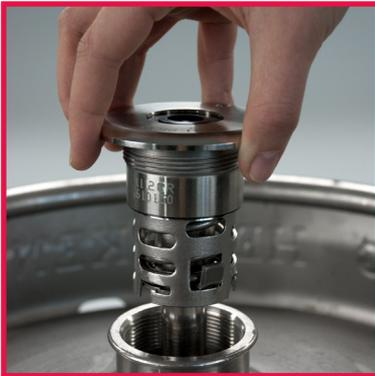
4. Überprüfen Sie den Sicherheitsriegel. Führen Sie den Fitting gerade in die Öffnung der Kegmuffe ein.
