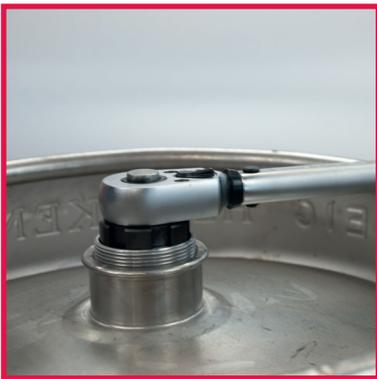
2. Drehen Sie den Fitting mit Hilfe des DSI Ein- und Ausschraubwerkzeuges völlig lose.
