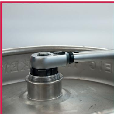
6. Fitting einschrauben und festziehen mit dem DSI Einschraubwerkzeug und dem Drehmomentschlüssel. Das Drehmoment muß 80 +/- 5Nm betragen.
