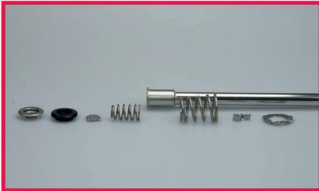
1. Ersetzen Sie die Gehäuse- und die Hauptdichtung. Legen Sie alle Teile zusammen.
