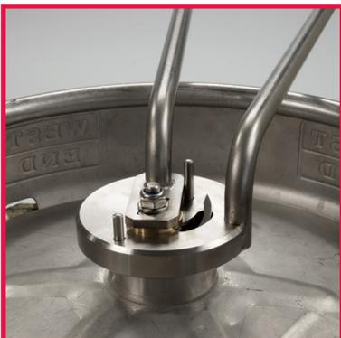
3. Schließen Sie die Griffe bis zum Haltestift. Die rechte Seite des Seegeringes erhebt sich. Drehen Sie das komplette Werkzeug mit geschlossenen Griffen etwa um 270° im Uhrzeigersinn bis der Seegering aus der Fassmuffe kommt.
