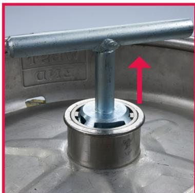
5. Nehmen Sie den Fitting aus dem Keg heraus indem Sie ihn gegen den Uhrzeigersinn drehen und anheben.
