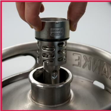
4. Führen Sie den Fitting gerade in die Öffnung der Kegmuffe ein. Die beiden äußeren Nocken des Fittinggehäuses mit den beiden Öffnungen der Fassmuffe ausrichten.
