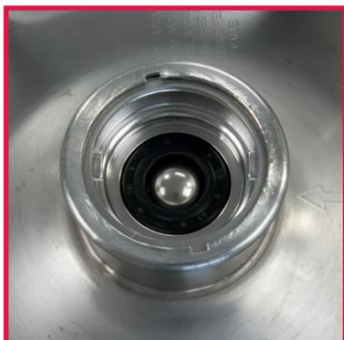
12. Drehen Sie die Griffe des Montagewerkzeuges senkrecht und nehmen Sie das Werkzeug ab. Das Keg ist gebrauchsfertig.
