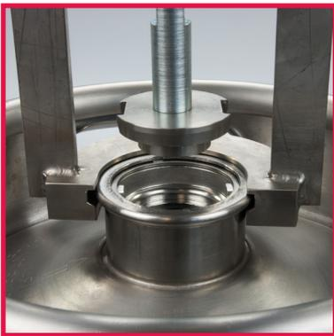
2. Legen Sie das Ringsegment des DSI-Montagewerkzeuges um die Fassmuffe. Richten Sie die Schlitze des Druckstückes des Montagewerkzeuges nach den Nocken des Fittinggehäuses aus durch Drehen des kompletten Werkzeuges.
