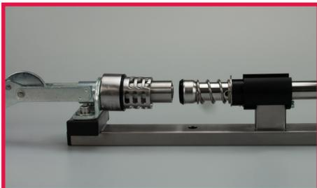
4. Drücken Sie den Hebel zurück. Nehmen Sie das Gehäuse und Steigrohr heraus.
