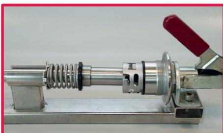
3. Drehen Sie das Gehäuse gegen den Uhrzeigersinn und schieben Sie es über die Ringmutter. Ziehen Sie den Griff nach hinten und entnehmen Sie das Gehäuse und das Steigrohr aus dem Werkzeug.
