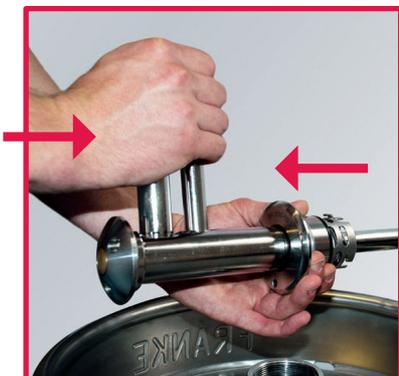
6. Halten Sie das Gehäuse mit einer Hand und drehen Sie das Werkzeug gegen den Uhrzeigersinn mit leichten Zug nach oben so lange, bis die Bajonettplatte einrastet. Durch Drücken der Griffe lösen Sie das Werkzeug vom Fitting.
