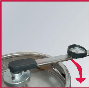
10. Schrauben Sie den Fitting mit dem DSI Ein- und Ausbauwerkzeug im Uhrzeigersinn fest. Drehmoment  $80 \pm 5$  Nm.
