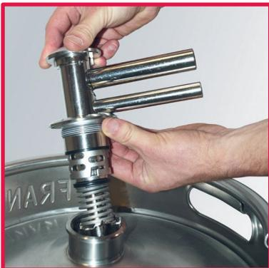
5. Ziehen Sie das Gehäuse nach oben gegen den Werkzeuggriff. Jetzt können Sie den Fitting aus dem Keg entfernen.
