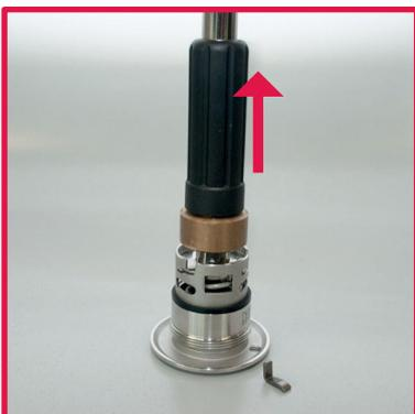
3. Entfernen Sie das (De-)Montagewerkzeug.
