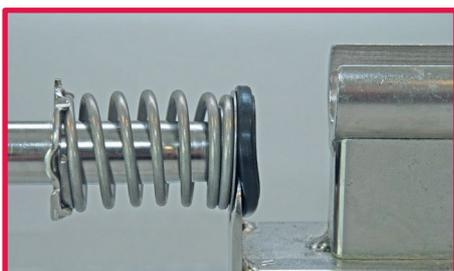
4. Entfernen Sie die Dichtung mit Hilfe der Gabel am Ende des Werkzeuges, indem Sie das Rohr von der Gabel wegziehen.
