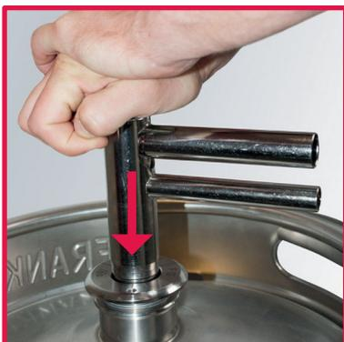
3. Drücken Sie das Ausbauwerkzeug auf das Gummiventil.
