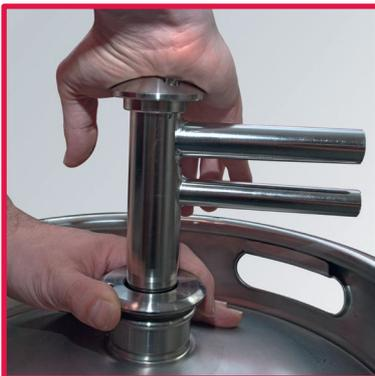
5. Drücken Sie das Werkzeug mit einer Hand nach unten, wobei der Flansch mit der anderen Hand festgehalten wird.
