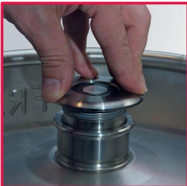
5. Drücken Sie den Fitting von Hand nach unten, der Sicherheitsriegel rastet unter der Kegmuffe ein.
