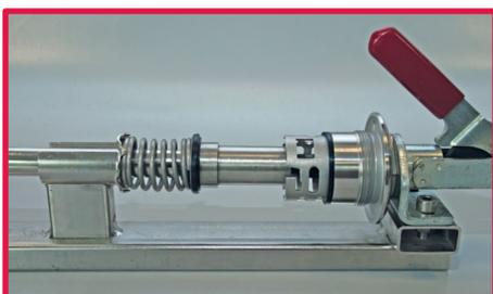
3. Drehen Sie das Gehäuse gegen den Uhrzeigersinn und schieben es über die Ringmutter. Ziehen Sie den Griff nach hinten und entnehmen das Gehäuse und das Steigrohr aus dem Werkzeug.
