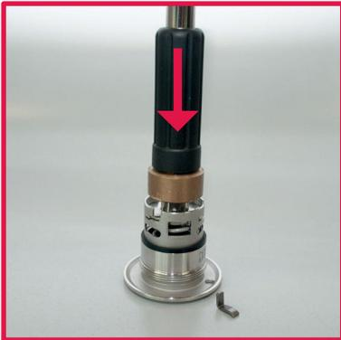
1. Drücken Sie das (De-)Montage Werkzeug mit den beiden Stiften in die Löcher, um die Feder zu entspannen.
