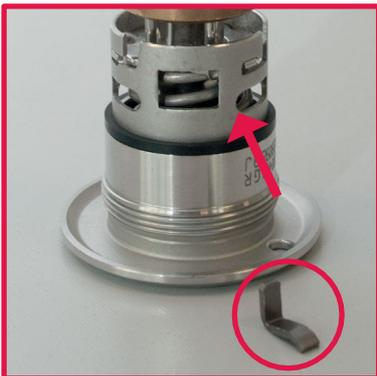
2. Positionieren Sie die Sicherheitsklinke mit der flachen Seite durch die Einfräsung des Gehäuses am Steigrohr, sodass die gebogene Seite in Richtung der Gehäuseoberseite zeigt (Fig. 21 Kreis).
