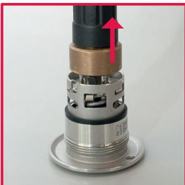
3. Entfernen Sie das (De-)Montage Werkzeug zum Spannen der Feder. Sollte diese nicht korrekt im Gehäuse sitzen, drücken Sie mit Hilfe eines Stiftes des (De-)Montage Werkzeuges gegen die Feder bis diese einrastet (Fig. 22 unterer Pfeil).
