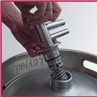
7. Ziehen Sie nun gleichzeitig das Werkzeug und den Fitting aus dem Keg heraus.
