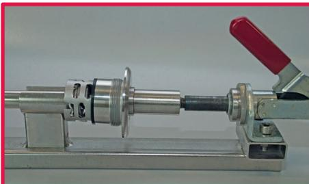
4. Ziehen Sie das Gehäuse zur Bajonettplatte und drehen es im Uhrzeigersinn. Prüfen Sie, ob das Gehäuse korrekt an der Bajonettplatte gesichert ist und die Ausfräsung der Sicherheitsklinke die korrekte Position hat.
