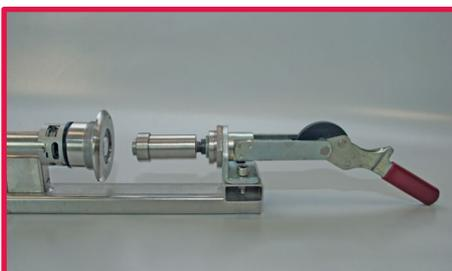
5. Drücken Sie den Griff nach hinten, um die Feder zu spannen und entnehmen Sie den Fitting. Bitte überprüfen Sie den korrekten Sitz der Dichtungen. Für die Installation der Sicherheitsklinke folgen Sie den Anweisungen auf der Seite 18.
