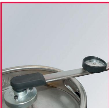
6. Schrauben Sie den Fitting mit dem DSI Ein- und Ausbauwerkzeug im Uhrzeigersinn fest. Drehmoment  $80 \pm 5$  Nm.
