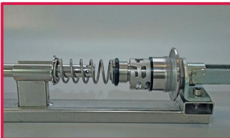
2. Platzieren Sie alle Teile in der korrekten Reihenfolge auf dem Steigrohr und setzen dieses in das Werkzeug.
