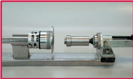
1. Ziehen Sie den Griff des Werkzeugs nach hinten und platzieren Sie den Fitting in die Halterungen.
