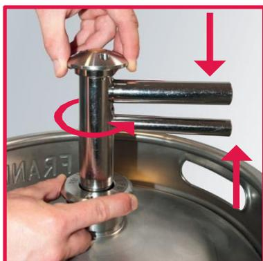
8. Jetzt drehen Sie das Werkzeug weiterhin mit einem leichten Zug nach oben gegen den Uhrzeigersinn, bis Sie merken, dass sich das Gehäuse mitdreht. Lösen Sie das Werkzeug durch Zusammendrücken der beiden Griffe. Die Bajonettplatte ist im Gehäuse verriegelt.
