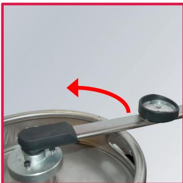
2. Schrauben Sie den Fitting gegen den Uhrzeigersinn mit dem DSI Ein- und Ausbauwerkzeug komplett aus.
