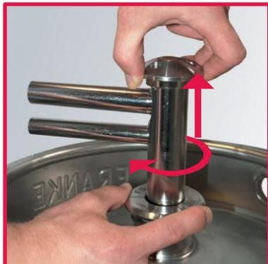
7. Halten Sie das Gehäuse mit einer Hand fest und drehen Sie das Werkzeug mit einem leichten Zug nach oben im Uhrzeigersinn, bis es einrastet.
