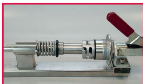
3. Zentrieren Sie die Feder zwischen den Führungen an der Bajonettplatte. Montieren Sie das Ventil auf dem Steigrohr, indem Sie den Griff nach vorne ziehen.
