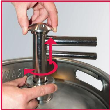
4. Heben Sie das Werkzeug mit dem verriegelten Fitting ein wenig an und drehen Sie ihn im Uhrzeigersinn, um die Bajonettplatte zu entsperren. Halten Sie währenddessen mit der anderen Hand den Flansch fest.
