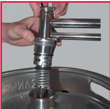
6. Ziehen Sie das Gehäuse nach oben und führen Sie den Fitting durch die Öffnung der Kegmuffe ein.
