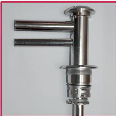
5. Halten Sie das Gehäuse mit einer Hand und drehen Sie das Werkzeug im Uhrzeigersinn, um die Bajonettplatte zu entsperren.
