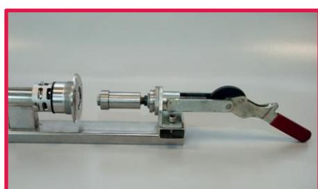
5. Drücken Sie den Griff nach hinten, um die Feder zu spannen und entnehmen Sie den Fitting. Bitte überprüfen Sie den korrekten Sitz der Dichtungen. Der Fitting ist jetzt einsatzbereit.
