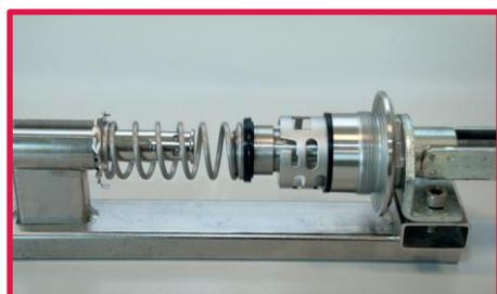
2. Platzieren Sie alle Teile in der korrekten Reihenfolge auf dem Steigrohr und setzen Sie dieses in das Werkzeug.
