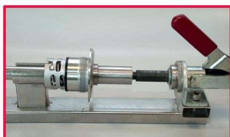
4. Ziehen Sie das Gehäuse zur Bajonettplatte und drehen Sie es im Uhrzeigersinn. Prüfen Sie, ob das Gehäuse korrekt an der Bajonettplatte gesichert ist.
