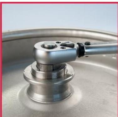
6. Fitting einschrauben und festziehen mit dem DSI-Einschraubwerkzeug und einem Drehmomentschlüssel.
