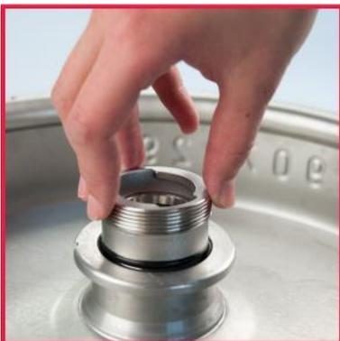
5. Drücken Sie den Fitting von Hand nach unten, die Sicherheitsklinke rastet unter der Kegmuffe ein.
