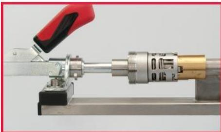
2. Ziehen Sie den Hebel nach vorne, um die Feder zu spannen. Drücken Sie die Sicherheitsklinke leicht nach innen. Ziehen Sie das Gehäuse nach unten und drehen es gegen den Uhrzeigersinn bis es ausklickt.
