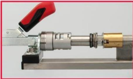
3. Ziehen Sie den Hebel nach vorne, um die Feder zu spannen.
