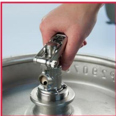
3. Montieren Sie das Demontagewerkzeug wie bei einem normalen Zapfkopf und drücken Sie den Hebel hinunter bis zum Anschlag. Die Sicherheitsklinke wird eingezogen.
