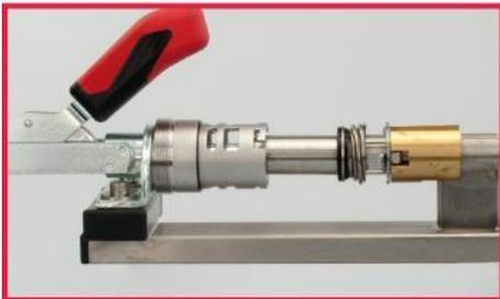
3. Bewegen Sie das Gehäuse nach oben und fixieren es durch Drehen an den Nocken.
