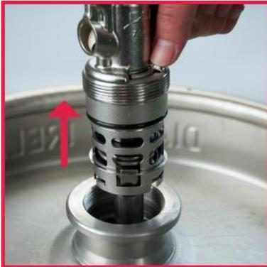
4. Nehmen Sie den Fitting heraus und lösen Sie das Werkzeug.
